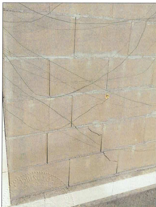
Trhliny a spáry v NS po ukončení zkoušky
