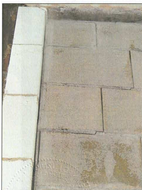
Spáry na boku a v horním levém rohu a na horní hraně vzorku – 31. minuta
