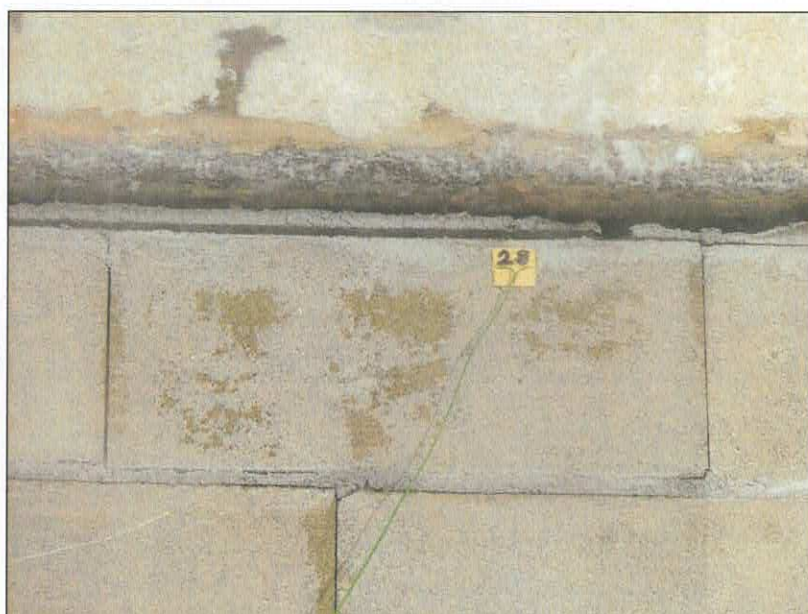
Spáry na boku a v horním levém rohu a na horní hraně vzorku – 31. minuta
